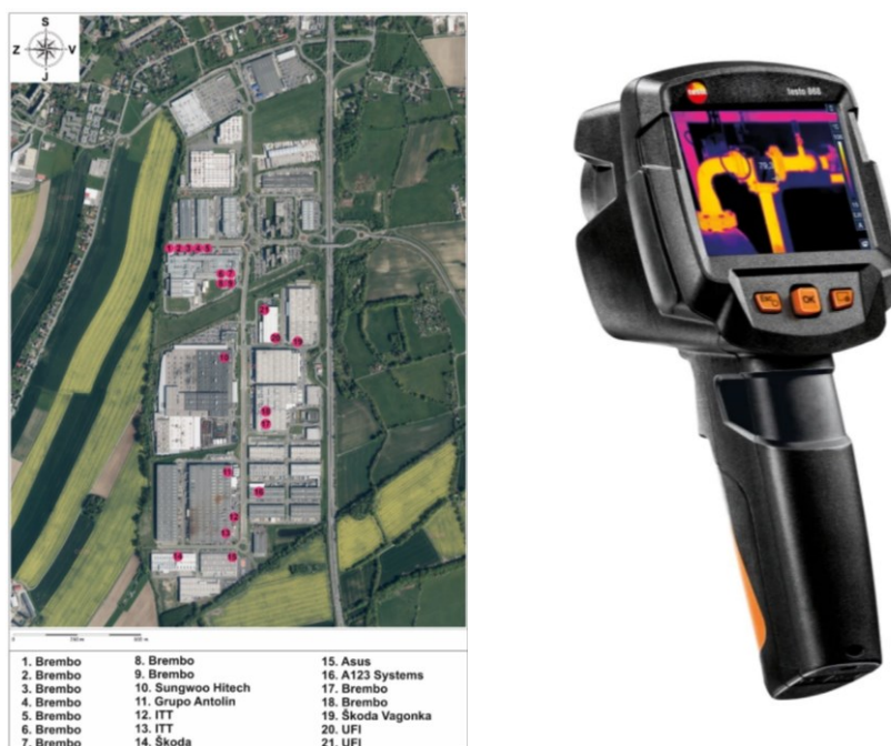
Obr. 4 Mapa zobrazující rozmístění vzorkovacích bodů pro jednotlivé budovy a jejich části, ze kterých byly pořízeny „termosnímky“ (vlevo), Termokamera testo 868s (vpravo) (Testo 2025).
