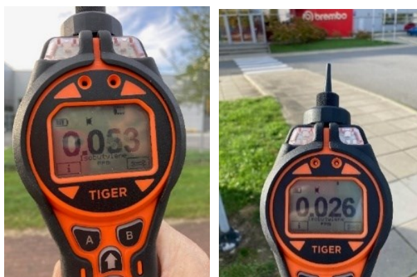
Obr. 28 Kontinuální měření analyzátořem VOC – Tiger během hodinového odběru vzorku vzdušiny na trubičku MARKES. Hodnota 0,053 ppm odpovídá 217 \mu\text{g}/\text{m}^3 a hodnota 0,026 ppm (vrátnice Brembo Czech, s.r.o.) odpovídá 106 \mu\text{g}/\text{m}^3 dne 19.10.2024.
