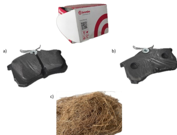
Obr. 54 Analyzované vzorky a) brzdové obložení; b) lak brzdového obložení; c) kokosová vlákna.
