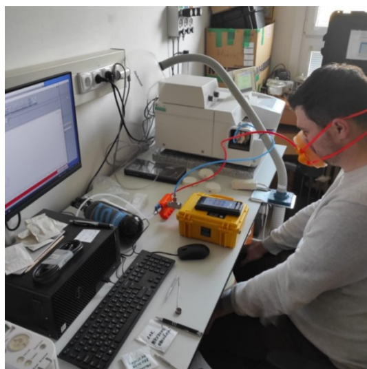
Obr. 55 Panelista měří zápach pomocí olfaktometru SM 100i.
