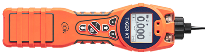
Obr. 5 Přístroj TIGER pro měření koncentrace VOC.
