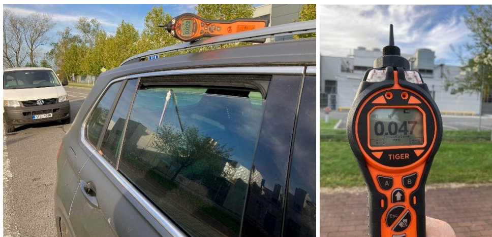
Obr. 27 Dokumentace aktivního odběru vzorku na trubičku MARKES a kontinuální měření analyzátořem VOC – Tiger. Hodnota 0,047 ppm odpovídá 192 \mu\text{g}/\text{m}^3 dne 19.10.2024.
